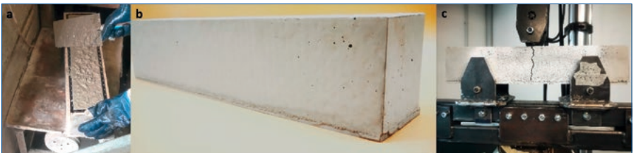
Versuchskörper einer Beton-GFK-Hybridstruktur a) Herstellung b) Endzustand c) Biegeprüfung der Probe
