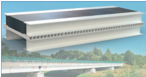
Abb. 1: Darstellung des neuen Schalungskonzepts (Composite Schalung)
