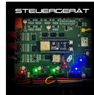
Das Team Steuergerät entwickelt die zentrale Steuereinheit, die Schnittstelle der gesamten Fahrzeugelektronik. Es nutzt den CAN-Bus für die Kommunikation zwischen den Systemen und integriert ein umfangreiches Datenlogging, um alle wichtigen Fahrzeugdaten zu erfassen und auszuwerten.
