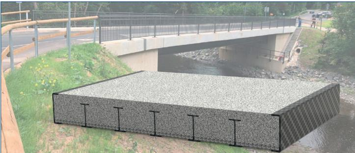
*Abb. 1: Darstellung des neuen möglichen Schalungskonzepts (Composite Schalung)*
