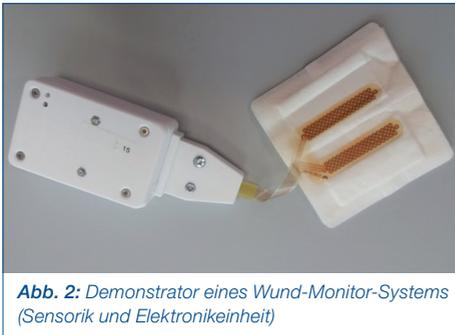
**Abb. 2:** Demonstrator eines Wund-Monitor-Systems
