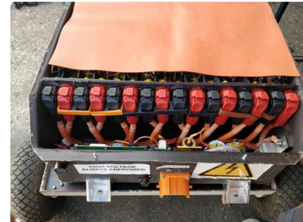
Für die Versorgung des Rennwagens mit elektrischer Energie ist die Baugruppe BMS (Batterie-Management-System) zuständig. Wir arbeiten an der elektrischen Umsetzung der Akkubox, von der Entwicklung eines eigenen BMS bis zur Umsetzung des Ladegerätes. Unser Augenmerk liegt vor allem auf der richtigen Handhabung der Akkuzellen, um einen Akkubrand zu verhindern und trotzdem die maximale Leistung des Akkus abzurufen.
