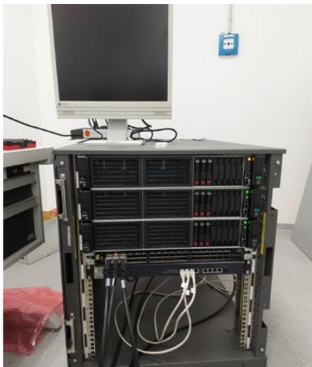
Die Rechner wurden von der Firma HPE (Hewlett Packard Enterprise) produziert und sind mit jeweils zwei AMD Prozessoren mit je 48 Kernen bestückt. Für die rechenintensiven Arbeiten benötigt ein HPC neben vielen Prozes-
