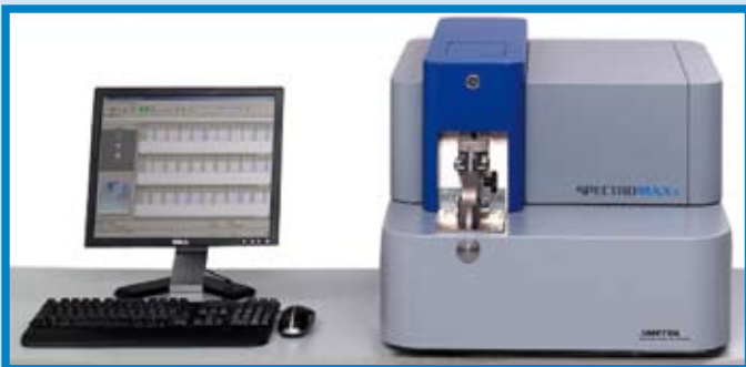
Das neue Gerät zur Analyse von metallischen Werkstoffen an der FHWT am Standort Diepholz „SPECTROMAXx, Version M“ aus dem Hause Spectro (Bildquelle: Fa. Spectro)
